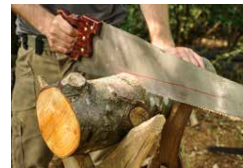
↑ Zaag de stam rondom in tot de lijn op de zaag.
