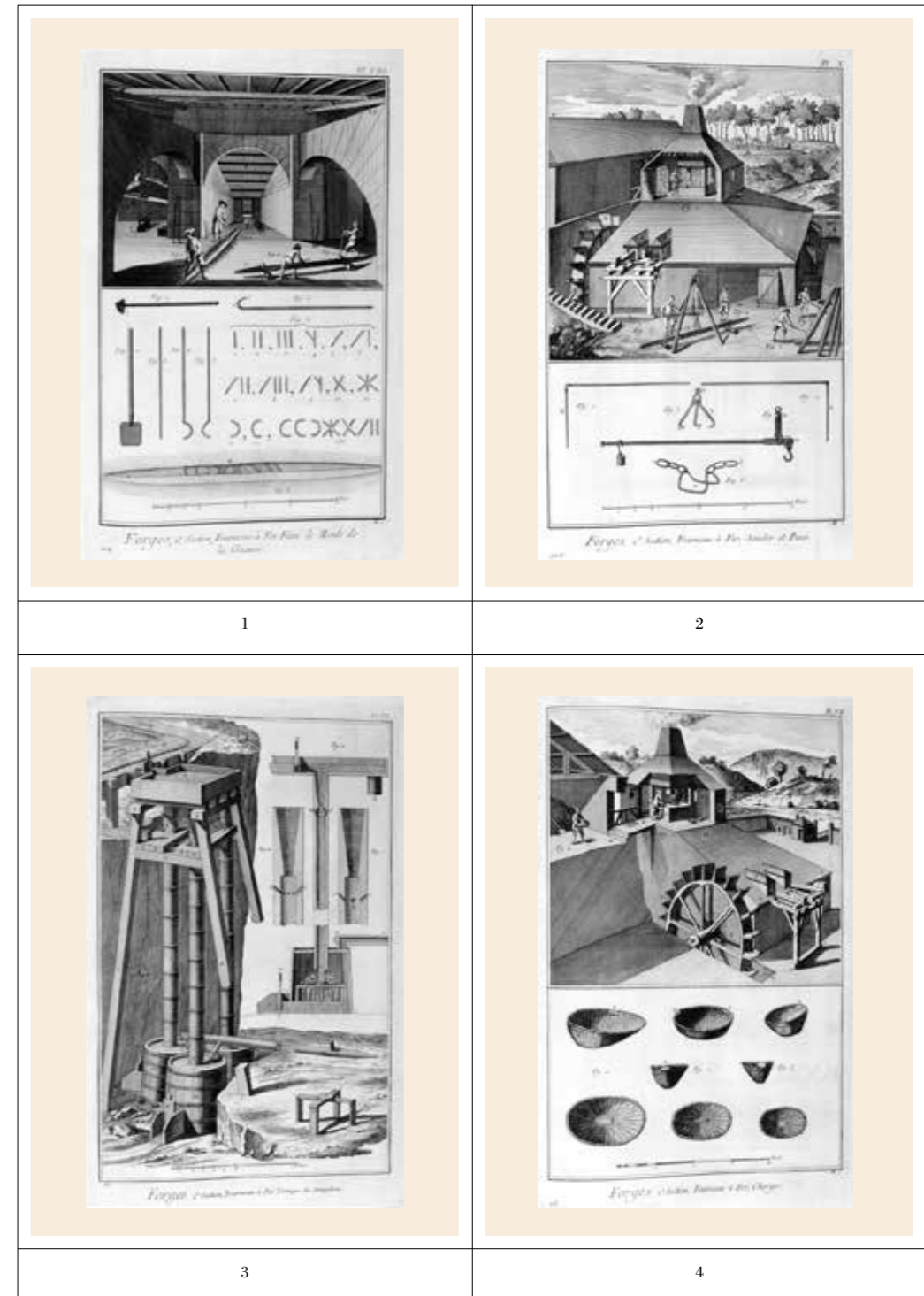
1-4 Illustraties uit 'Smederijen, of de kunst van het ijzer maken', Encyclopédie , Vol. 4, 1765, redactie Denis Diderot en Jean le Rond d'Alembert. Plaat 1 toont de hoogoven en het gieten van de vorm voor het ruwijzer, 2 toont het proces van inspecteren en wegen van het ijzer, 3 toont de smeltapparaat en op plaat 4 zien we hoe het erts in de hoogoven gaat, en de manden waarin de erts en houtskool worden vervoerd.
